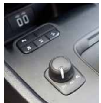
▶ Vše kolem pohonu 4x4 se volí elektronicky pomocí těchto ovladačů. Včetně redukce.
